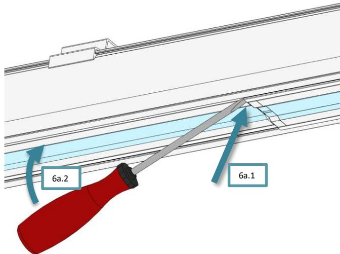
Mit Hilfe eines flachen Schraubendrehers vorsichtig die Aluminiumkante der Lichtbandeinheit aufhebeln (6a.1 und 6a.2). Wichtig: Nur die Aluminiumteile mit Schraubendreher berühren und sicherstellen, dass die Optikteile (Kunststoff) unbeschädigt bleiben.
