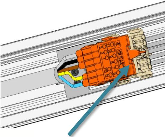
**3e.** Die Endkappenschrauben und Kabelverdrahtung fest anziehen. Die Endkappe auf dem anderen Ende des Lichtbands kann jetzt auch installiert werden.
