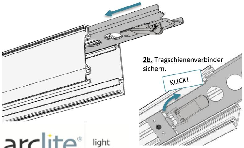
2c. Montage von Halterungen (Abbildung 1) vor der nächsten Tragschienenmontage wiederholen. Die Schienen zusammen schieben (2c.1), Tragschienenverbinder beidseitig sichern (2c.2) und die Stromeinspeisungsbuchse LBK2/11 CON KU mit Tragschienenstecker LBK 2/11 CON ST verbinden (2c.3)
