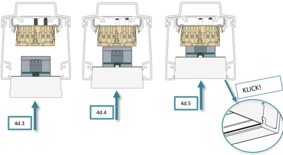
**4e.** Verbinden Sie folgende Lichtbandeinheiten ähnlich wie die erste. Schieben Sie diese bis zum Kontakt mit der vorhergehenden Einheit.
