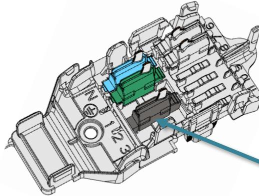
Phase kann im Lichtbandeinheit-Stecker zwischen 1-3 mit schiebbarem Phasenwähler gewählt werden.
