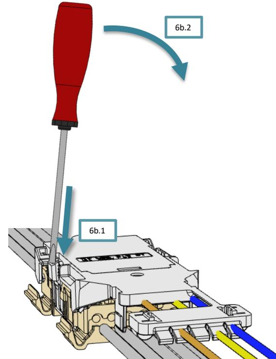
**6c.** Beim Ausbau von 3-Phasen-Stromschieneneinsatz öffnen Sie die zwei Befestigungsschrauben und abkoppeln Sie den Stecker wie vorher gezeigt.
