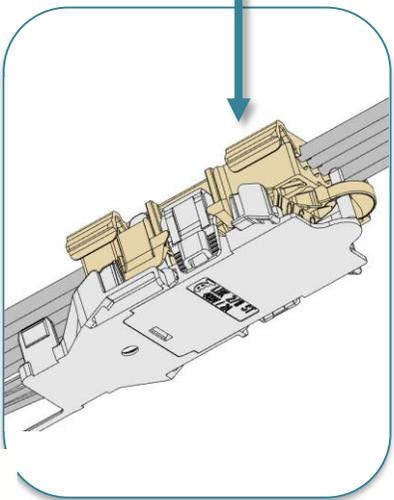
4d. Lichtbandeinheit gleichmäßig und gerade in die Tragschiene drücken und in Richtung Endkappe schieben (4d.1 und 4d.2)
