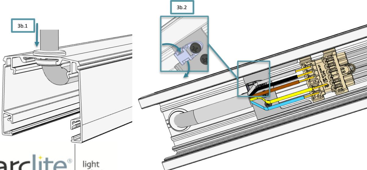
**3c:** Stromeinspeisung-Buchse LBK2/11 CON KU mit richtigen Adern verbinden (je nach Anzahl der Adern)
